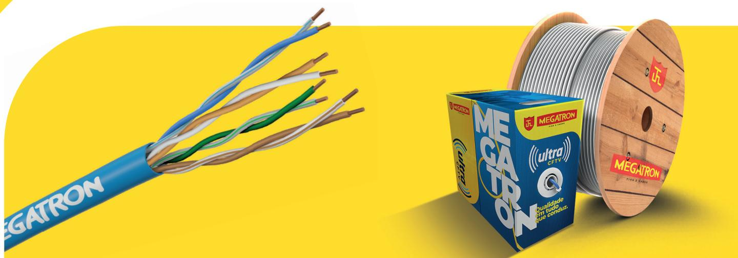
O cabo **MEGATRON ULTRA CFTV** é constituído por condutores em liga de Alumínio Acobreado – CCA, isolado em material termoplástico, binados e reunidos, formando o núcleo, que é revestido por uma capa termoplástica em PVC retardante a chama, com classificação CMX e aplicação destinada a sistemas de CFTV.
