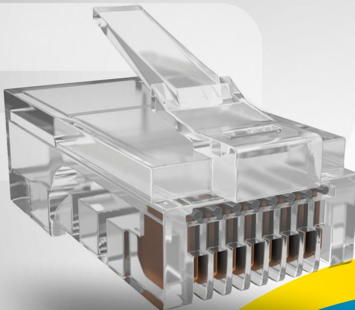
O conector RJ 45 Cat.5e Macho simples, ultrapassa os requerimentos EIA/TIA -568 de performance, garantindo o melhor desempenho em redes. Possui uma camada de 3 microns de ouro.
